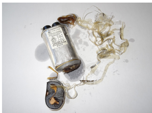
Fonctionnement interne d'un condensateur à micro-ondes
