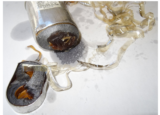
Comme le montre le démontage, le condensateur micro-ondes est un condensateur fortement imprégné
