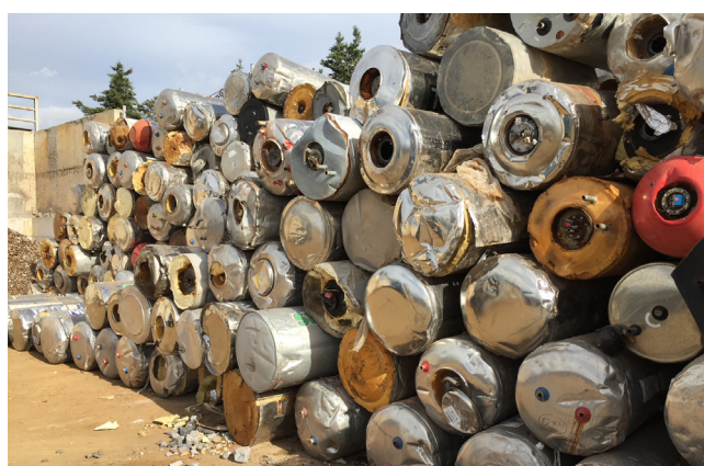
Figure 4: chaudière avant le décollage et le traitement manuel des mousses PU dans les installations de recyclage de réfrigérateurs (photo reproduite avec l'aimable autorisation de RAL-Gütegemeinschaft Rückproduktion von Kühlgeräten e.V., 2020).
