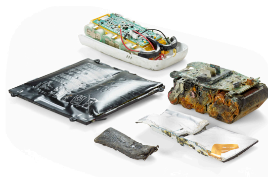
Le risque d'incendie est particulièrement élevé avec les batteries lithium défectueuses. (Photo: INOBAT)
