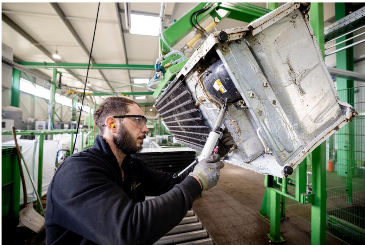
Stufe 1 des Recyclingprozesses: Kältemittel werden aus den Kühlgeräten gesaugt.
